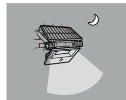
**Modo 3:** Permanece el 40% de luz (el sensor PIR está apagado).
